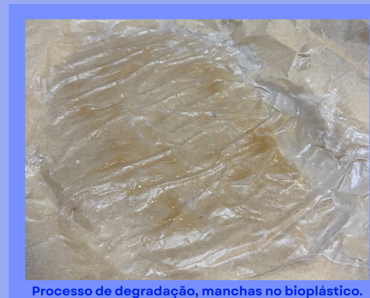
Processo de degradação, manchas no bioplástico.
